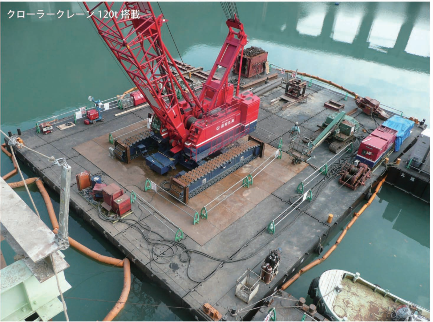
フロート台船寸法 L9.0m×W2.5m×H2.0m
